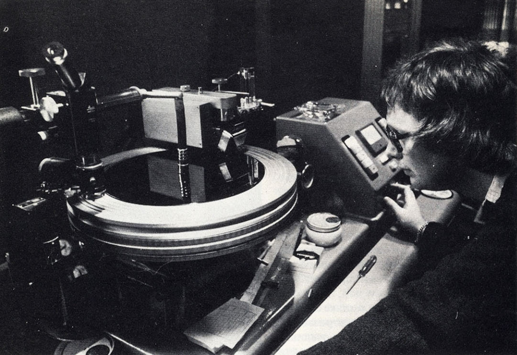
Нарезание бороздок на новом диске На стр. 63: вкладывание готовой грампластинки в обложку
